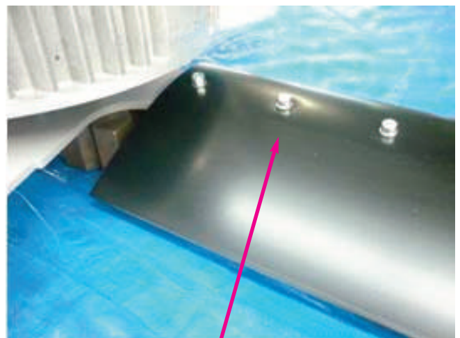
Oberer Teil des Flügels ist mit Sicherungsmutter befestigt.
